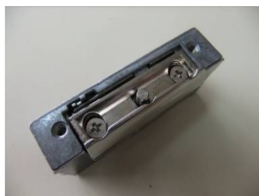
Eliminamos la placa exterior
